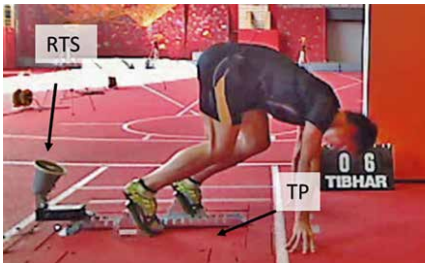
Slika 1. Postavitev merilnega mesta in merjenca na merilnem mestu. RTS – ReacTime System; TP – tenziometrijska plošča.
